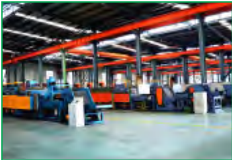
Trattamento termico-Trasportatore a rulli in linea continuo Heat treatment-continual roller mesh belt line
