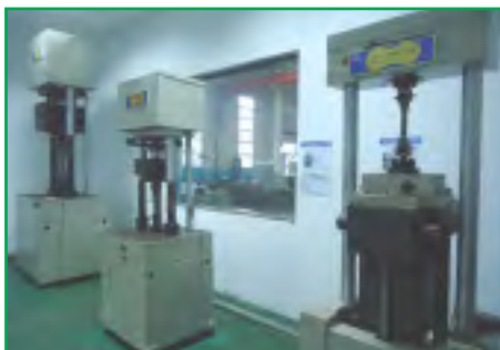
Test resistenza a fatica della catena Chain fatigue strength test
