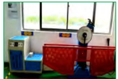
Test di resilienza Material impact testing machine
