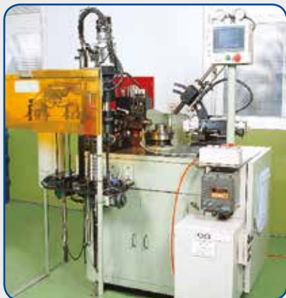
Ingrassaggio automatizzato Grease filling machine
