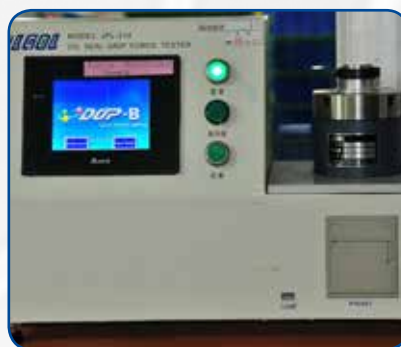
Test Carico Radiale Radial force tester
