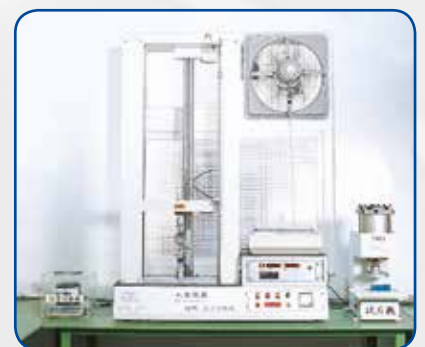
Test rottura Tensile Strength (Lab)
