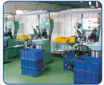
Macchina automat. per Finitura Auto Trimming
