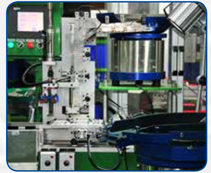
Montaggio Molle Automatico Auto spring mounting
