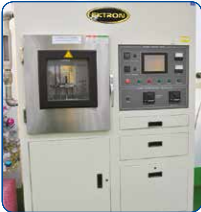
Test resistenza ozono Ozone Resistance Tester
